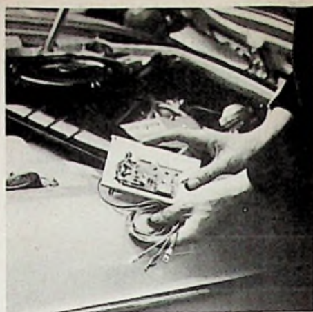
Afb. 4. De elektronische ontsteking gereed om in de auto te worden ingebouwd.
